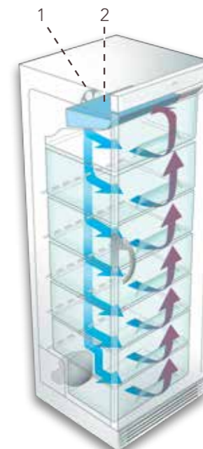
NoFrost-Technik 1 Ventilator 2 Kälteerzeuger
